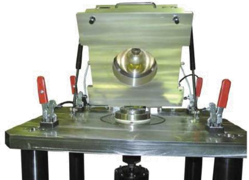
光加熱装置部（供試体バルブシート/フェイス面）
