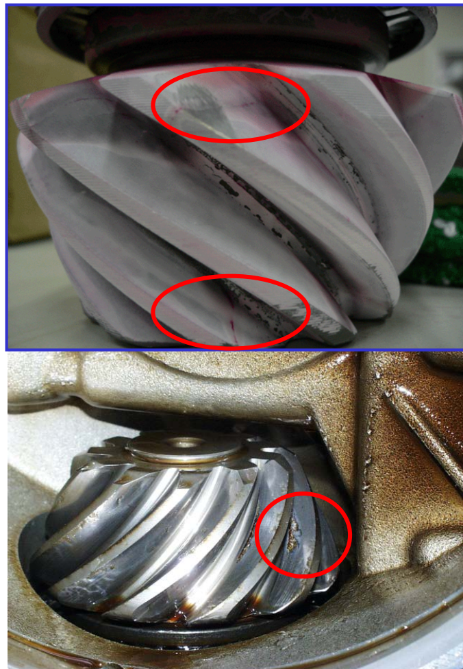
歯車破損、ピッチング...
